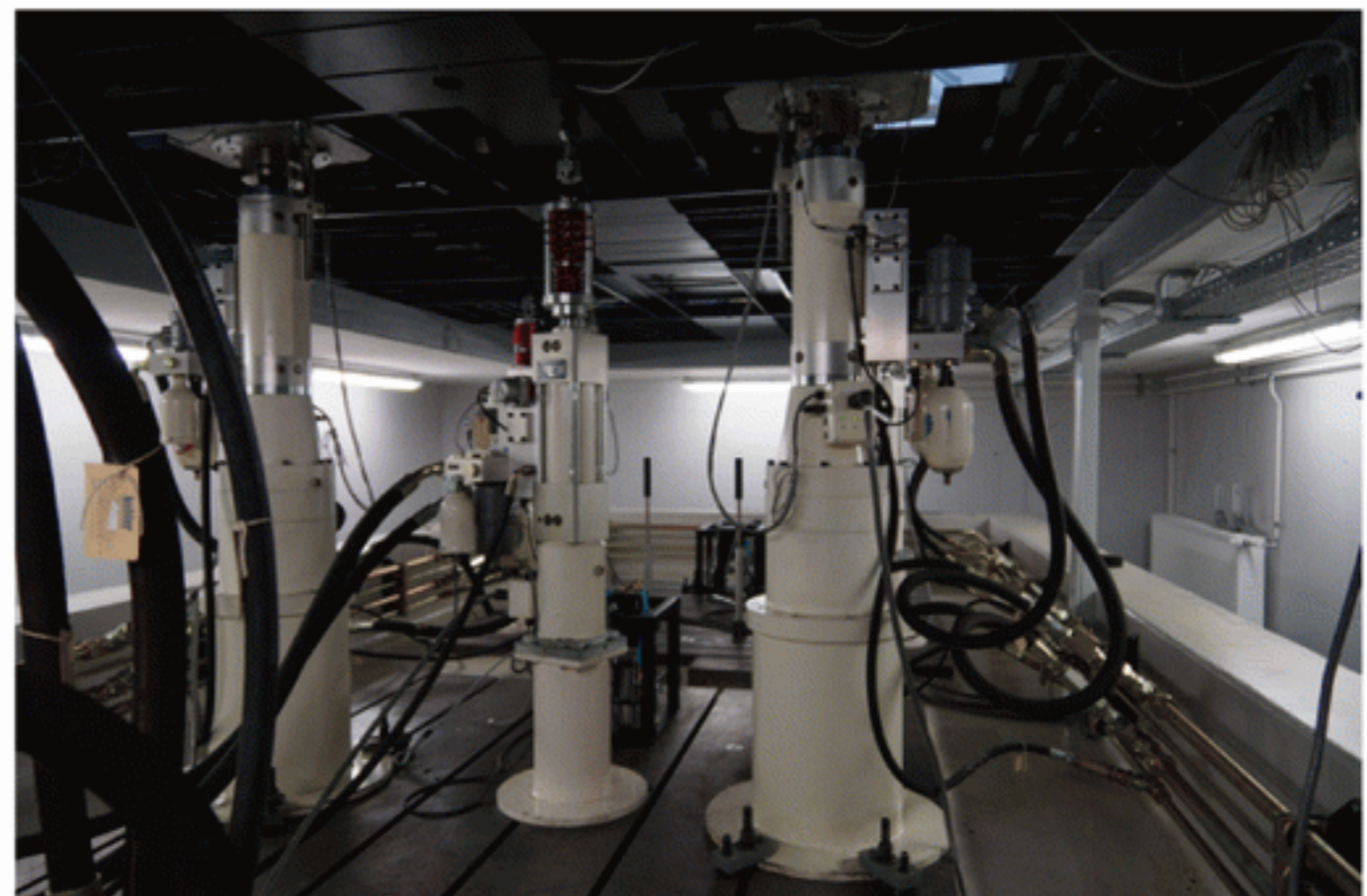
Schaubild 1-6-2 7-Post-Unterboden-Dynamikprüfstand des deutschen Fahrwerkherstellers KW
