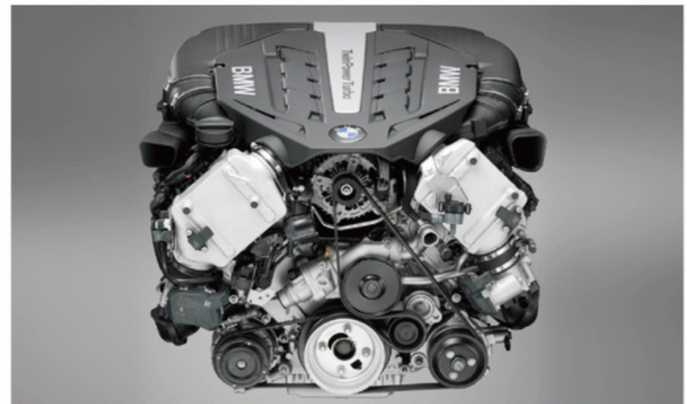
Beispiel für den Otto-Kreisprozess. TwinPower Turbo V8-Benzinmotor der Marke BMW.
