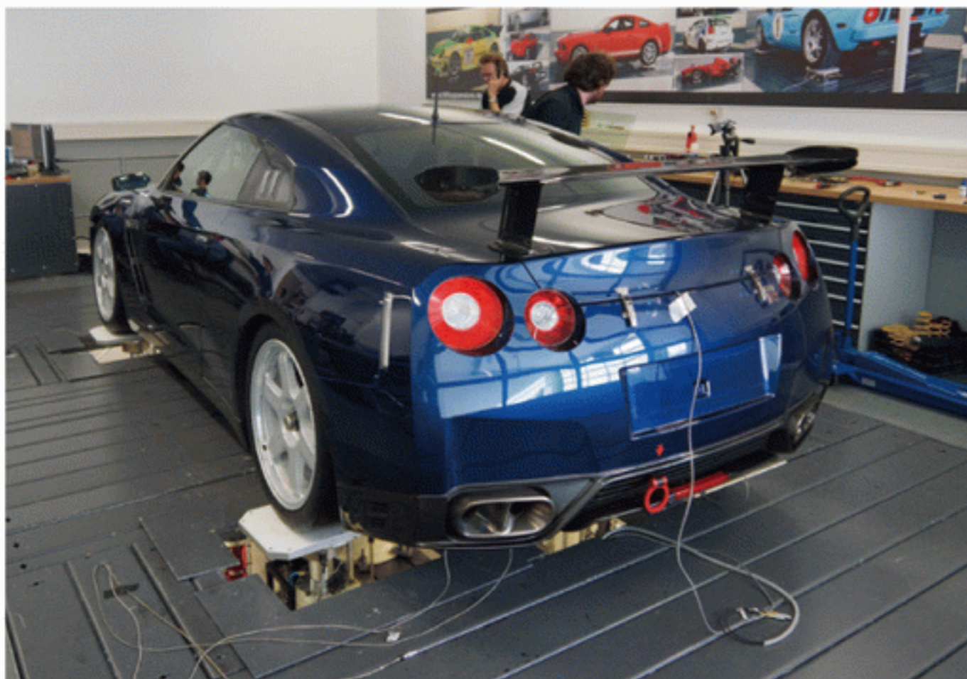
Schaubild 1-8-3 Evaluierung der Aufhängung des GT-R, der auf dem Nürburgring angetreten ist, was ein Testen der Aufhängung bei unterschiedlichen Schwingungsfrequenzen und die Analyse des Frequenzverhaltens beinhaltet.
