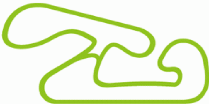
Auf einer Strecke mit vielen Kurven sollte das Übersetzungsverhältnis aller Zahnräder nah beieinander liegen, um die Beschleunigungsleistung zu erhöhen.
