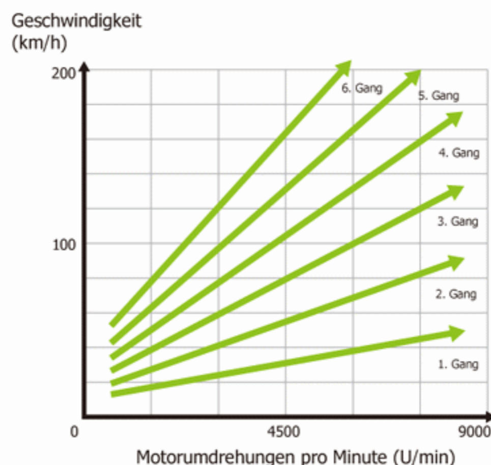
Auf Hochgeschwindigkeitsstrecken mit langen Geraden bewirkt ein höheres Übersetzungsverhältnis eine erhöhte Höchstgeschwindigkeit.
